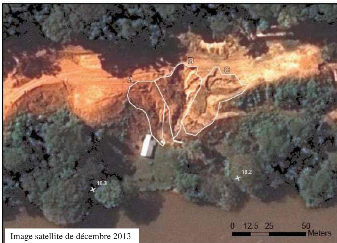
2.37. Selon M. Kondolf, «ces ravines s'étendent sur 80 m de largeur (dans la direction parallèle au rivage) et sur 50 m à l'horizontale entre le sommet et le pied du talus de remblai»<sup>133</sup>. Il estime que
