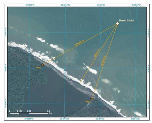
Figure 83 : Distance entre l'emplacement estimé de la borne initiale et le point terrestre le plus proche sur une image satellite du 22 janvier 2016, et entre cet emplacement et les points Plw2 et Ple2 mesurés lors de la seconde visite sur les lieux.
