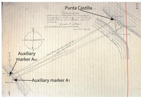
Figure 5 : Croquis figurant dans la minute  $n^{\circ}$  XX des actes de la commission de démarcation Costa Rica-Nicaragua (1897-1900) et montrant l'emplacement de Punta de Castilla et des bornes auxiliaires  $A_m$  et  $A_1$ , ainsi que leurs positions respectives indiquées par des distances et des azimuts.
