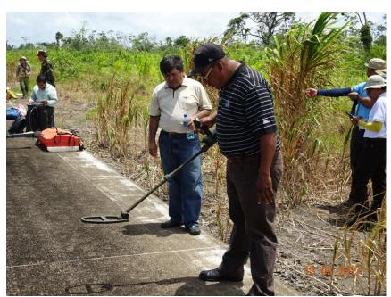
Figure 63 : Inspection, au moyen du détecteur de métaux fourni par le Nicaragua, de la portion de 180 mètres de la piste d'atterrissage de l'aéroport de San Juan del Norte ayant fait l'objet de notre inspection. Photographie prise lors de la seconde visite sur les lieux, le 13 mars 2017.
