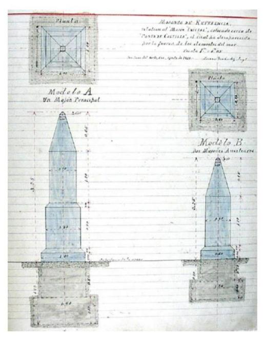
Figure 55: Croquis présentant les caractéristiques et paramètres géométriques des deux types de bornes placées pour permettre, à tout moment, la localisation précise de Punta de Castilla et de la borne initiale ( $minute\ n^*\ XX\ des\ commissions\ de\ démarcation\ Costa\ Rica-Nicaragua$ ).
