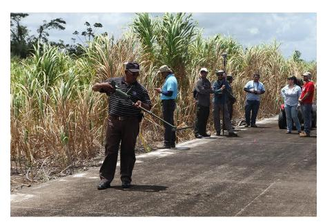
Figure 12 : Examen de la piste d'atterrissage à l'aide du détecteur de métaux (VALLON modèle VMH3CS) fourni par le Nicaragua.
