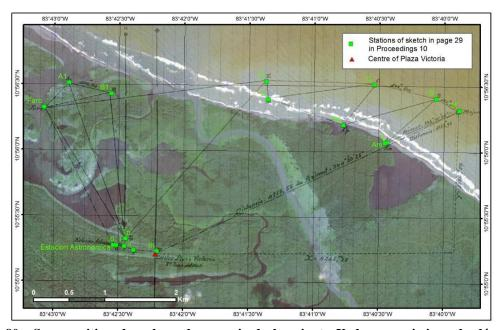
Figure 80 : Superposition du calque du croquis de la minute X des commissions de démarcation Costa Rica-Nicaragua (1897-1900) et de l'image satellite de 2009. Ce calque a été établi à partir des coordonnées calculées pour le centre de Plaza Victoria et des données de triangulation figurant dans la minute X.
