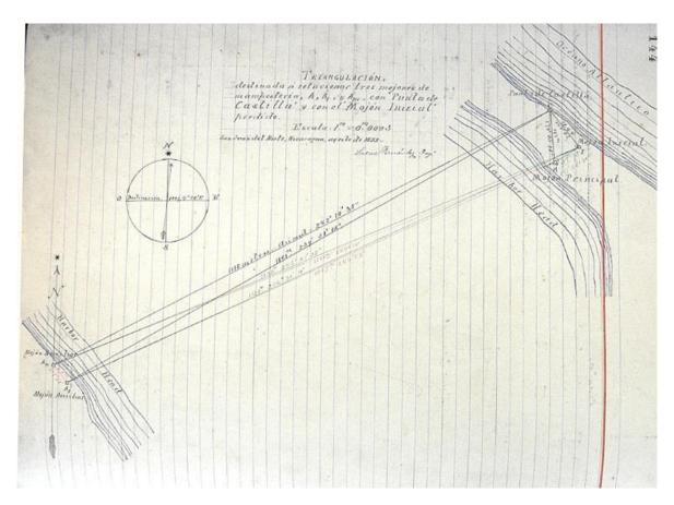
Figure 54: Mesures de triangulation effectuées en août 1899 entre Punta de Castilla (C), la borne initiale (I), la borne principale (A) et les bornes auxiliaires ( $A_m$  et  $A_1$ ). Il convient de noter que Punta de Castilla se trouve à 91,44 m au nord-ouest (140° 52') de la borne initiale (minute  $n^{\bullet}XX$  des commissions de démarcation Costa Rica-Nicaragua).
