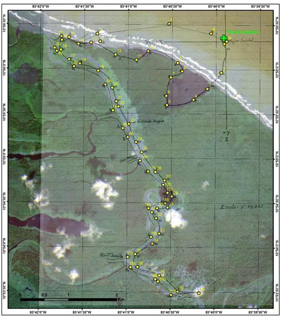
Figure 86 : Superposition du croquis géoréférencé de la minute n° X des commissions de démarcation Costa Rica-Nicaragua de 1899 et d'une image satellite obtenue en 2009, qui fait apparaître que la côte a reculé de quelque 940 mètres du côté oriental de la lagune de Los Portillos/Harbor Head.
