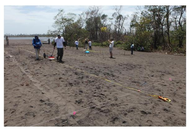
Figure 61: Inspection au moyen du géoradar de la zone couvrant les coordonnées mesurées par le Nicaragua pour la borne localisée en 2003 sous les eaux de la lagune de Los Portillos/Harbor Head. Au total, 12 profils de 27 mètres de long, situés à deux mètres d'intervalle, ont été obtenus. Les fanions roses marquent les extrémités des profils, au départ et à l'arrivée).
