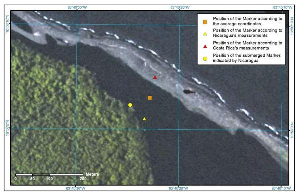
Figure 60 : Projection sur une image satellite de 2003 des coordonnées mesurées par le Nicaragua et le Costa Rica pour les bornes localisées en 2003 sur la plage (le carré représentant les coordonnées moyennes et les triangles, celles communiquées par les Parties) et sous les eaux de la lagune (cercle jaune).
