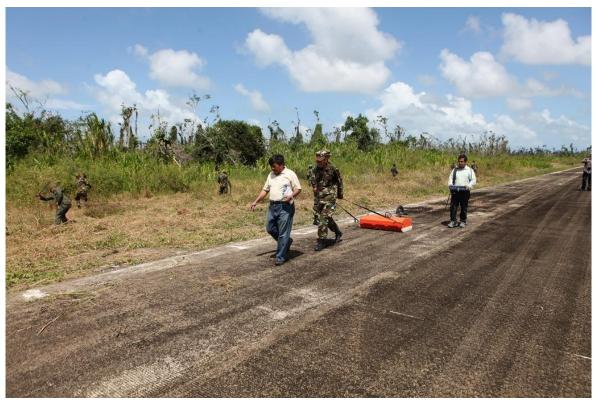
Figure 64: Prospection, au moyen d'un géoradar (radar à pénétration de sol, ou RPS) de la délégation nicaraguayenne équipé d'une antenne blindée de 200 MHz, à la recherche de la borne de Plaza Victoria sous la piste d'atterrissage de l'aéroport de San Juan del Norte. La photographie montre également le défrichage en cours sur le flanc nord de la piste avant le passage du géoradar et du détecteur de métaux. Photographie prise lors de la seconde visite sur les lieux, le 13 mars 2017.
