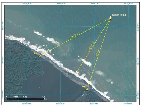
Figure 82 : Distance entre l'emplacement estimé de la borne initiale et le point terrestre le plus proche sur une image satellite du 22 janvier 2016, et entre cet emplacement et les points Plw et Ple mesurés lors de la première visite sur les lieux.
