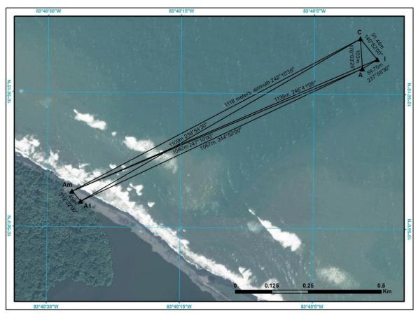
Figure 81 : Schéma de triangulation figurant dans la minute XX des commissions de démarcation Costa Rica-Nicaragua (1897-1900) projeté sur une image Worldview de 2016. La lettre «I» désigne la borne initiale et la lettre «C», Punta de Castilla.
