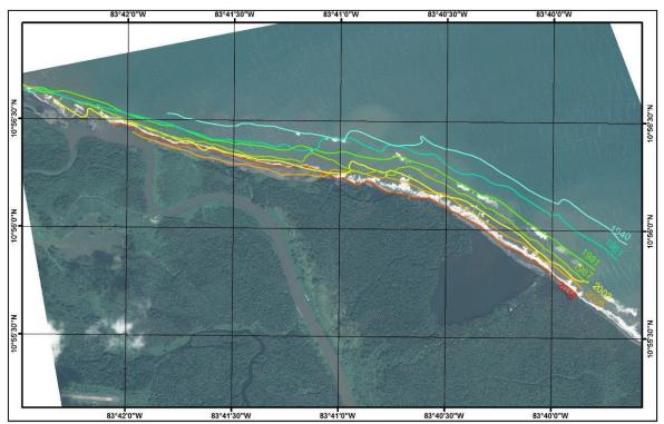
Figure 87 : Image satellite de 2016 montrant la position du littoral, cartographié à l'aide d'images satellite de différentes dates (1940, 1961, 1981, 1987, 2002, 2009 et 2016).
