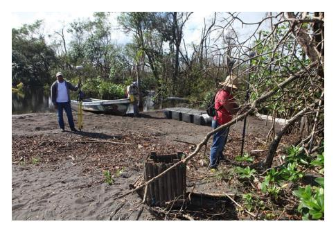
Figure 28 : Point Plw relevé lors de la première visite sur les lieux à l'extrémité occidentale de la lagune de Los Portillos/Harbor Head. Il se situait au niveau d'une laisse de haute mer établie suivant le tracé constitué par des végétaux échoués indiquant le niveau le plus élevé atteint par les eaux de la lagune après le passage de l'ouragan Otto. Photographie réalisée le 6 décembre 2016.
