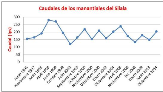
Figura 5.4 Caudales totales aforados en los manantiales del Silala; tomados del reporte de SERGEOTECMIN (2002).
