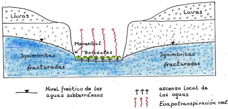
Figura 3.7 Situación hidrogeológica en el área del Silala. Según investigaciones en los Manantiales del Silala, SERGEOTECMIN (Diciembre 2004).
